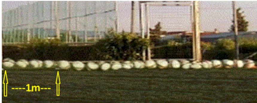
Σχήμα 4: Η κίνηση μια μπάλας μετά από ένα σουτ όπως καταγράφεται με την τεχνική straw motion
